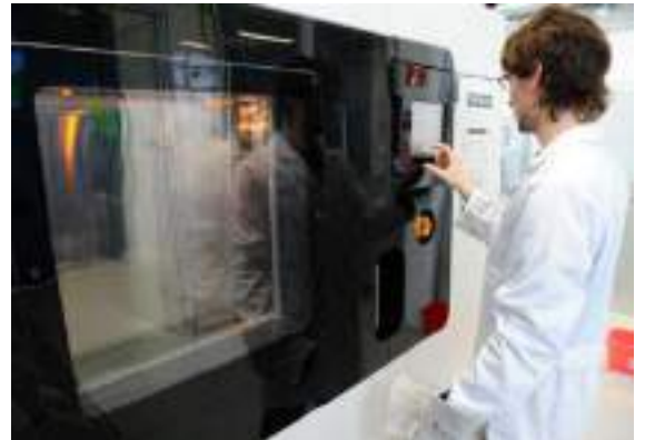
Esquema de la tecnología Modelado por deposición fundida. A la derecha, operario programando la Fortus 900 para la fabricación por FDM
