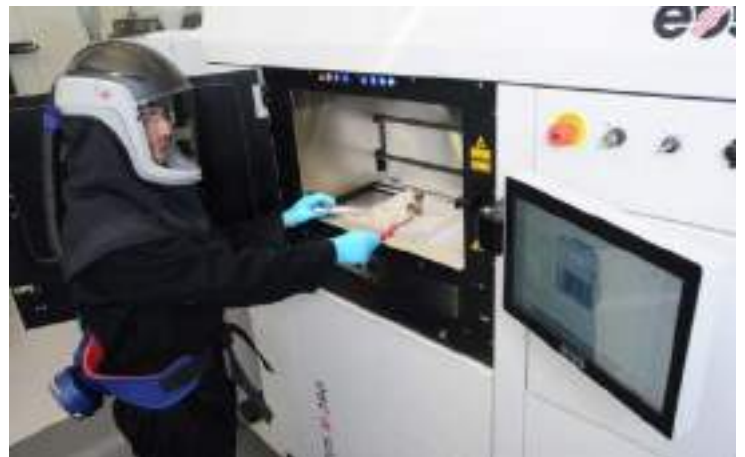
Esquema de la tecnología de fusión de lecho de polvo. A la derecha, operario manipulando una pieza tras su fabricación por PBF en la EOS M290
