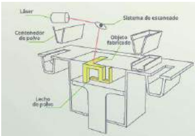
Esquema de la tecnología de fusión de lecho de polvo. A la derecha, operario manipulando una pieza tras su fabricación por PBF en la EOS M290
